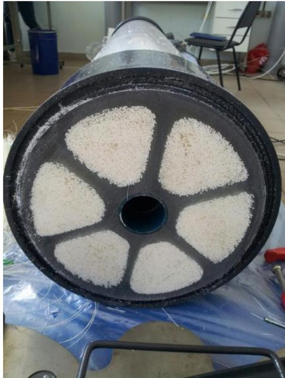
Половолоконный ультрафильтрационный модуль. Серийный выпуск
